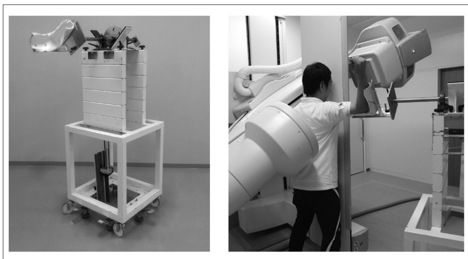
図3 投球後期コッキング期の運動を模倣するための装置 左：装置本体 右：撮像風景
